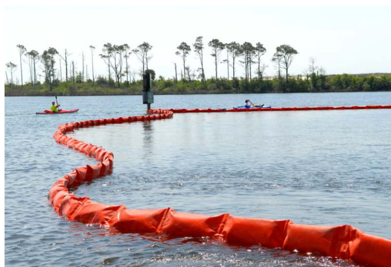
2. Боны – это плавучие ограждения, которые ограничивают распространение чего-либо по поверхности воды
